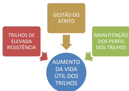
Figura 1: Pilares para o gerenciamento da interface roda-trilho.
