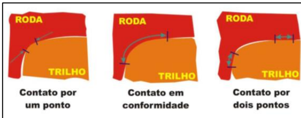
Figura 5: Tipos de contato roda-trilho.
