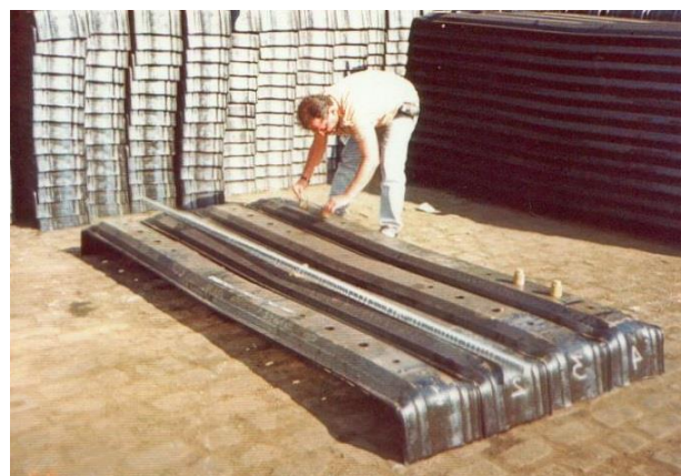
Fig. 17 Inspeção de DA de bitola larga na MRS.
