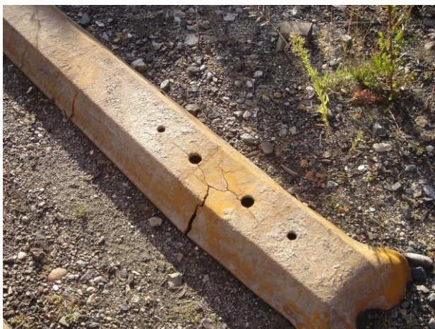
Fig.20 D. Aço na BC Rail (Canada) com trincas de fadiga entre os furos, perfil não UIC de 10mm.
