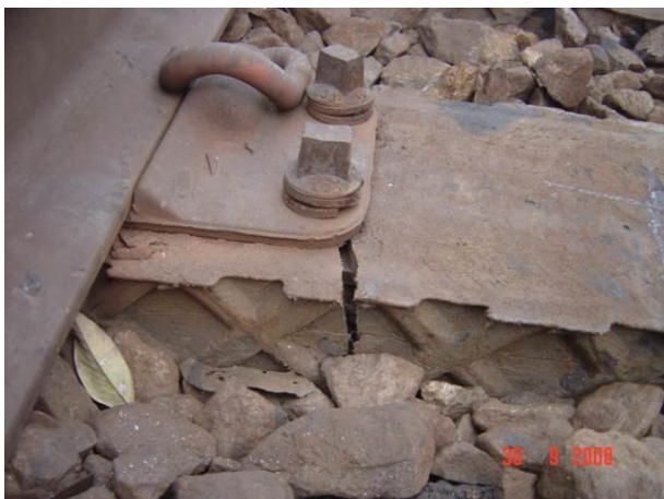
Fig. 7 Fratura do DPR na região de pregação.
